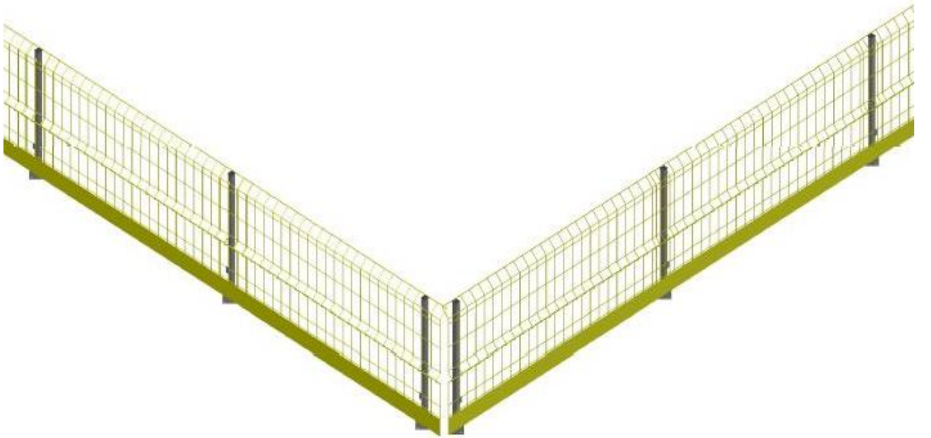
Şekil4.5. Köşe bölgeler için kenar koruma sistemi montaj örneği.
