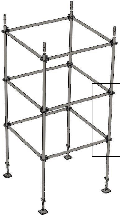
Şekil4.2. Dikey elemanlardaki fincan bölgelerine yatay elemanların montajı
