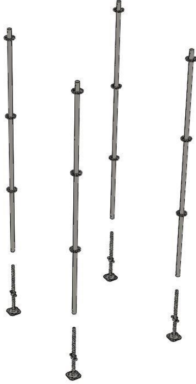
Şekil4.1. Alt ayar milleri üzerine dikey elemanların yerleştirilmesi
