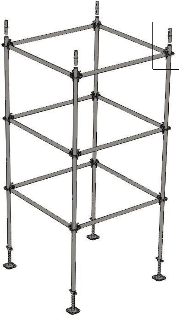
Şekil4.3. Ekleme elemanlarının montajı
