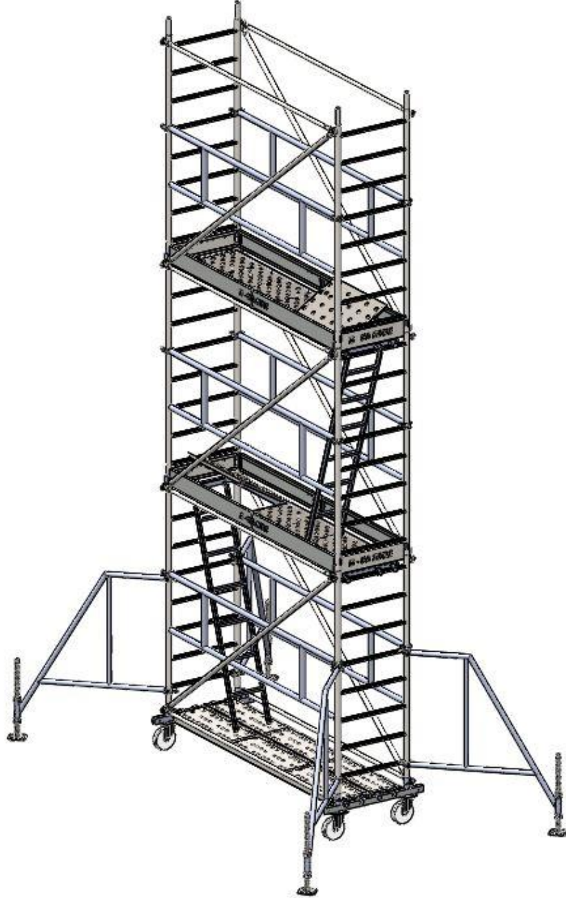
Şekil 7.1. İS-KA H tipi iki metal platformlu mobil iskele kurulum örneği
